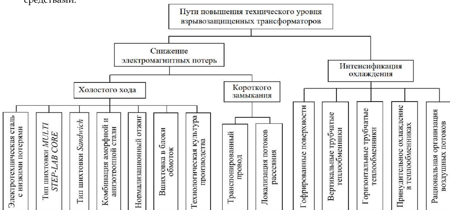
Рисунок. Пути повышения технического уровня взрывозащищенных трансформаторов
