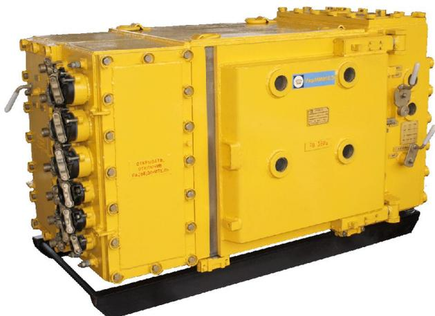
Устройство управления КУУВ-630 предназначено для работы в трехфазных сетях переменного тока с изолированной нейтралью трансформатора для дистанционного управления, контроля состояния, технической диагностики и защиты трехфазных электродвигателей с коротко-замкнутым ротором, установленных на машинах и механизмах угледобывающих комплексов напряжением 1140/660 и 660 В в выработках угольных шахт, опасных по газу (метану) и (или) угольной пыли.
