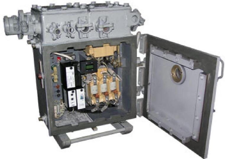
В данный пускатель встроен новый информационный блок, который не только отображает текущее значение потребляемого тока, величину напряжения сети, состояние защит и блока управления, но и позволяет сократить время на устранение возникших неисправностей за счет автоматической диагностики основных блоков пускателя.
