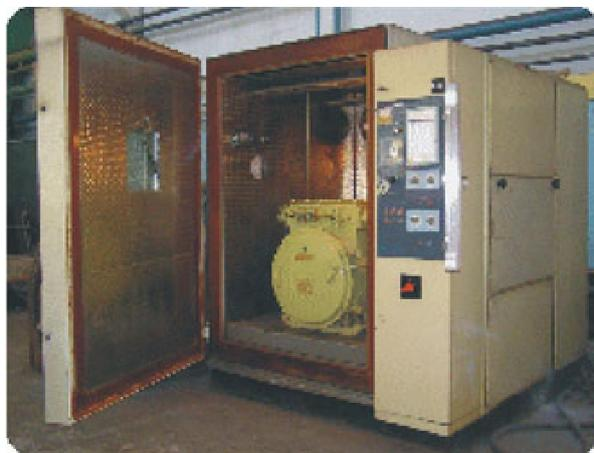
Лаборатория располагает 7 аттестованными стендами, камерами и устройствами для климатических и ударовибрационных испытаний и испытаний на степень защиты от IP54 до IP65.
